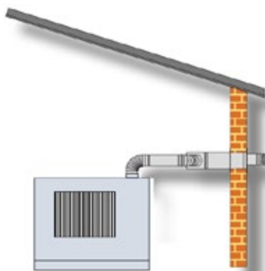
Sortie murale concentrique (type C12) Evite le percement du toit et la nécessité d'un solin
