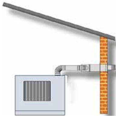
Balancierter Abgas-Wandanschluss (Typ C13) eliminiert teure Dachöffnung und Eindeckrahmen
