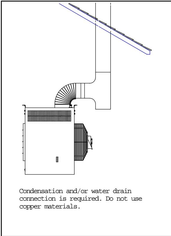
**Figure 6. HORIZONTAL FLUE CRITERIA**
