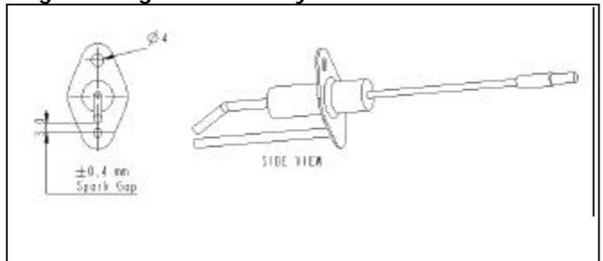
**Fig. 12b : Installing the ignitor**
