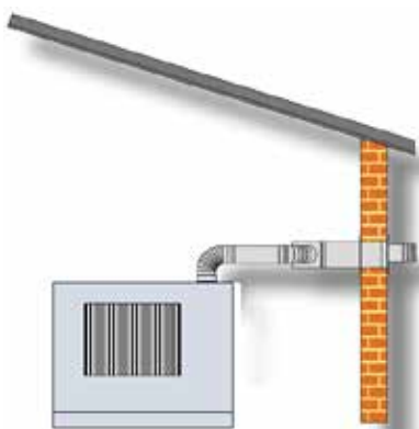
Sortie murale à conduit de fumée équilibré (type C13) élimine les ouvertures et les solins de toit coûteux
